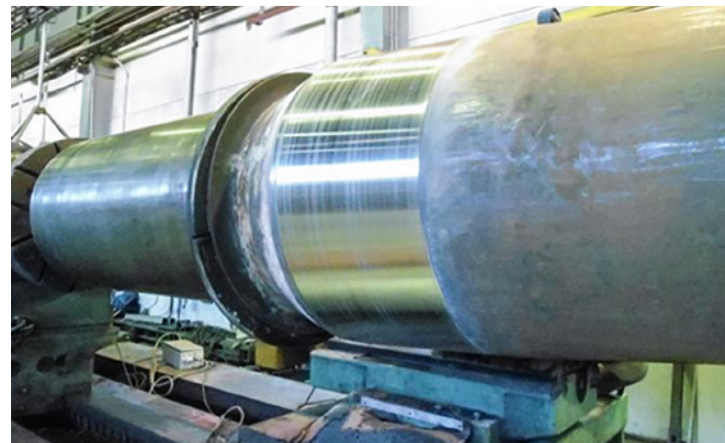
Karamurskaimen pääakselin kunnostus.
