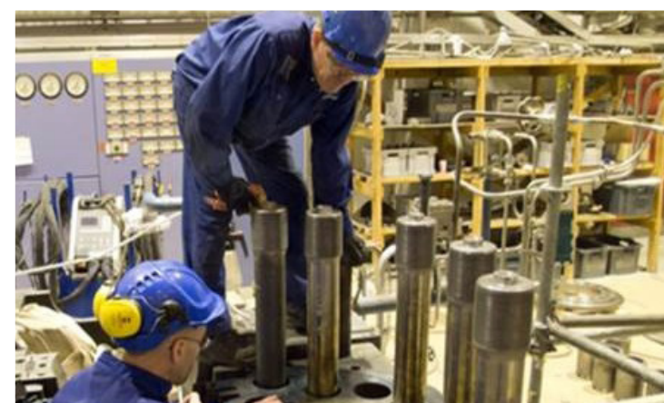
Turbiinin jakotason korjauskoneistuksen tarkastus.
