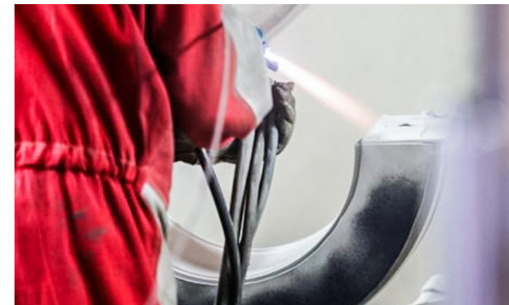
Valkometallilaakerin valmistus pinnoittamalla.
